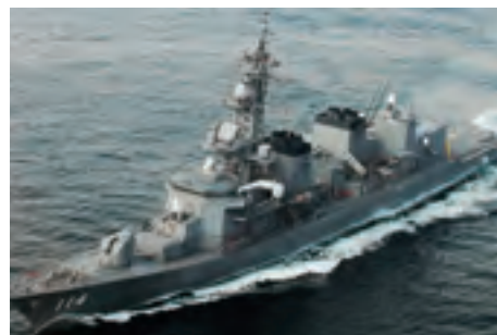
護衛艦「すずなみ」 基準排水量4,650t 速力30kt
